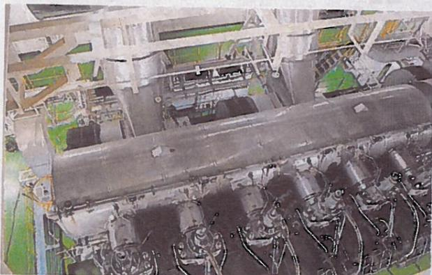
Vue de la machine, un seul moteur **MAN B&W** qui développe **63 910 kW**.
